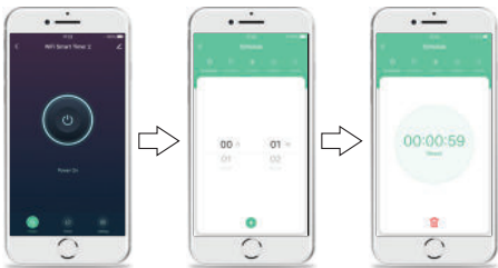
Πατήστε το "Timer" στην αρχική οθόνη του ρελέ Ορίστε την ώρα και τα λεπτά και πατήστε επιβεβαίωση Ο χρονοδιακόπτης θα ανοίξει (ON) και θα κλείσει (OFF) στον επιλεγμένο χρονικό διάστημα
