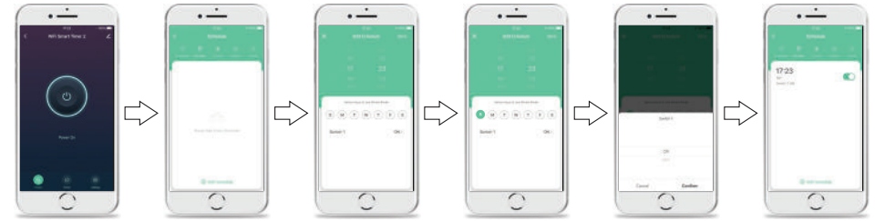
Πατήστε το "Timer" στην αρχική οθόνη του ρελέ Επιλέξτε "Schedule" και στην συνέχεια "Add Schedule" Ρυθμίστε την Ώρα και τις Ημέρες για το πρόγραμμα Επιλέξτε "Switch" για να ορίσετε το ON ή το OFF του ρελέ Επιλέξτε ON ή OFF, επιβεβαιώστε και αποθηκεύστε Μπορείτε να προσθέσετε περισσότερα σεναρία εάν το επιθυμείτε
